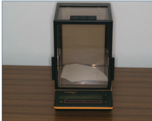
Abb. 5: Gravimetrische Bestimmung der Schweißmenge mit Fließpapier und Feinwaage.
